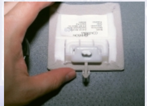
Zwischenstück mit der "Zündstelle" zum Auslösen des Airbags
