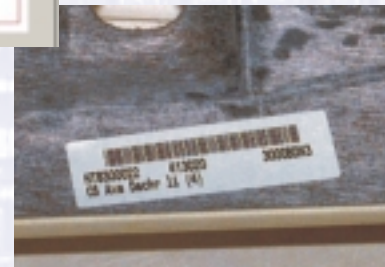
Eingangslabel mit Barcode, der zu Produktionsbeginn per Scanner aufgenommen wird
