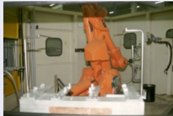
Kleberoboter zum Aufspritzen des Klebers für die nachfolgende Kaschierung der Säulen
