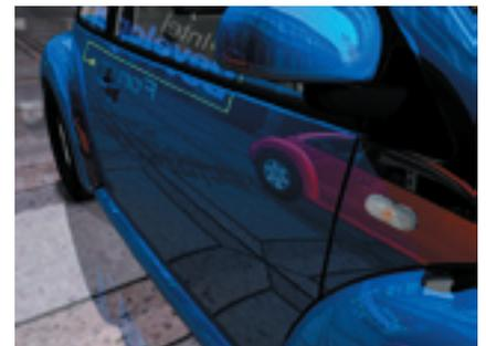
Im neuen Projekt-Visualisierungs-Zentrum des Volkswagen-Konzerns in Wolfsburg sind beispielsweise 40 Dual-Prozessor-PCs zu einem „Großrechner“ zusammenschaltet, um 20 Millionen Bildpunkte von 3D-Auto-Design-Studien in Originalgröße zu berechnen. Auf der „Powerwall“, einer Großprojektionswand von 5,10 x 2,10 m präsentiert, bietet sie Entwicklern eine ideale Möglichkeit, Lichtreflexe, Oberflächen oder auch besondere Lack- und Innenraumvarianten, wie an
