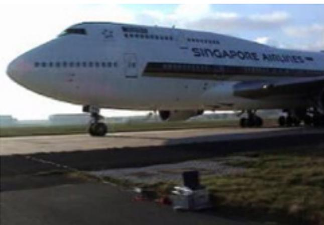
Test am Frankfurter Flughafen im Dezember 2001 zur Aufnahme des Magnetfeldprofils für Flugzeuge, Foto: ZIV GmbH
