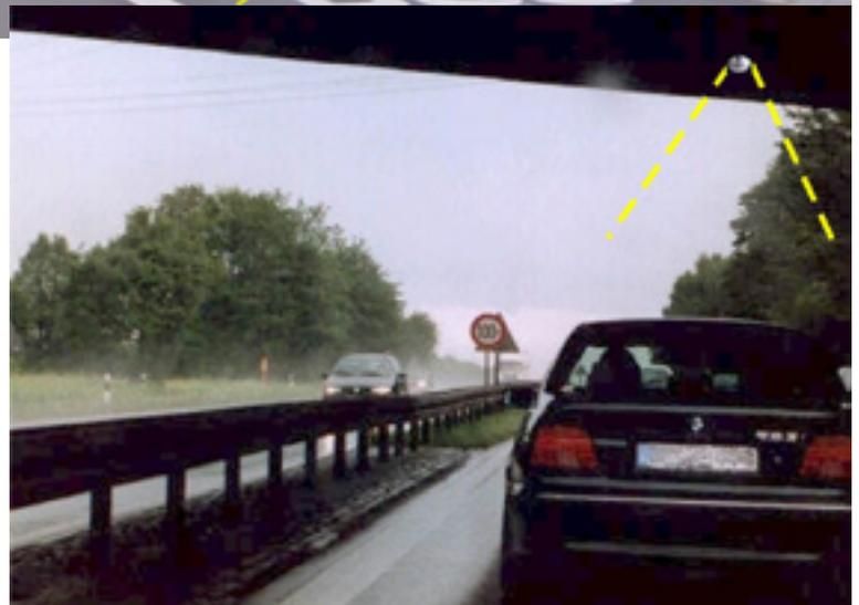
Funktionsprüfung der Sensoren bei unterschiedlicher Messanordnung: Im Bereich der stark befahrenen Rheinstraße, einer Haupteinfallssache in Darmstadt, wurde ein 3D-Sensor unterhalb der Fahrbahn in ein 80 cm tief liegendes Rohr eingebracht. Für eine Messung von oben nutzte man die Brücke am Ortseingang von Darmstadt, dem Autobahnende A672. Zusätzlich erfasste ein Referenzvideo die Fahrzeuge, um die Fahrzeugklassifizierung anhand der Messkurven genau zu belegen.
