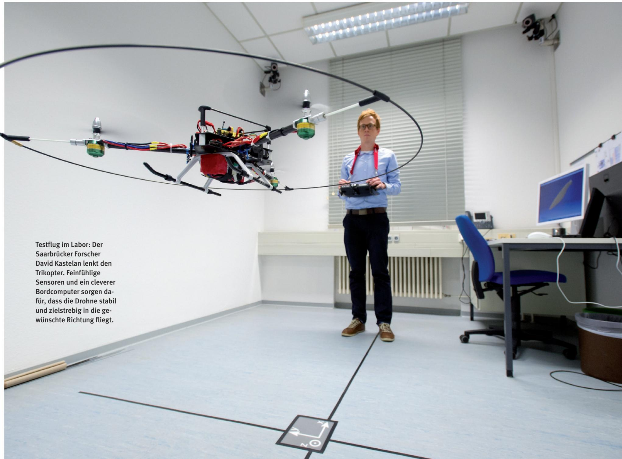
Testflug im Labor: Der Saarbrücker Forscher David Kastelan lenkt den Trikopter. Feinfühligere Sensoren und ein cleverer Bordcomputer sorgen dafür, dass die Drohne stabil und zielstrebig in die gewünschte Richtung fliegt.
