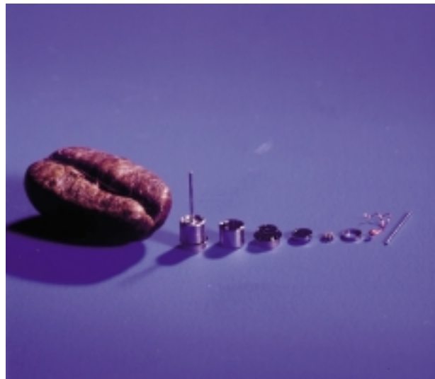
Elektrischer Mikromotor mit 2 mm Außendurchmesser. Der Motor besteht aus einer Kombination mikrotechnisch hergestellter Teile mit Elementen der Präzisions-Feinwerktechnik.
