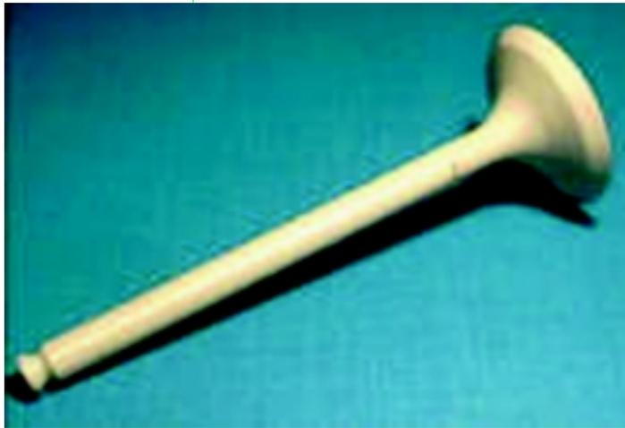
Der Einsatz neuer keramischer Werkstoffe, beispielweise aus Siliziumnitrid für Ein- und Auslassventile, ist dabei von großem Interesse. Geringe Dichte, gute Temperatur- und Korrosionsbeständigkeit versprechen Kraftstoffeinsparungen und Geräuschreduzierungen. Dem verstärkten Einsatz stehen die hohen Fertigungskosten sowie die Beherrschung der Massenproduktion in höchster Qualität und eine zuverlässige Qualitätskontrolle entgegen.
