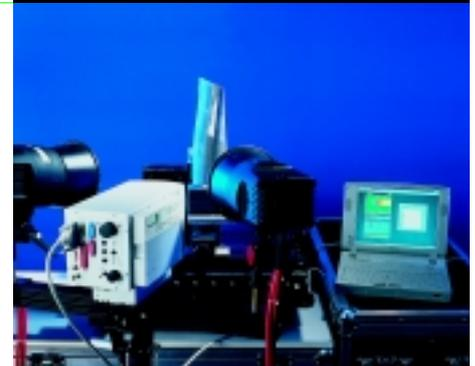
Meßanordnung der Hochgeschwindigkeits-Impulsthermographie
