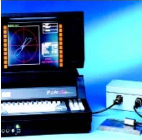
**WS98 – Digitales Mehrkanal- und Mehrfrequenz-Wirbelstrom-Prüfsystem**
