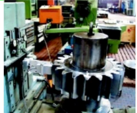
Meßaufbau zur Charakterisierung der Randschicht an einem Großgetriebezahnrads
