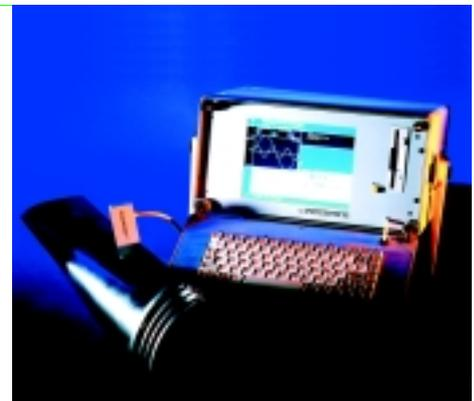
Electromagnetische Härte- und Eigenspannungsmessung nach dem Flammhärten an Niederdruckturbinenschaufeln
