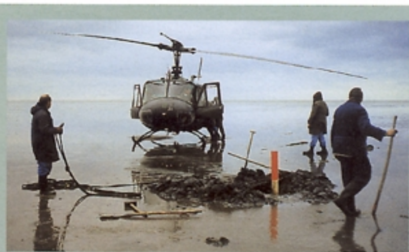
Ein Trupp von Wissenschaftlern im Nordseewatt der Melderfer Bucht bei der erfolgreichen Bergung des Testobjekts, das zuvor mit siebenfacher Schallgeschwindigkeit ins Watt geschossen wurde. Ein Hubschrauber unterstützt die Bergungsaktion.
