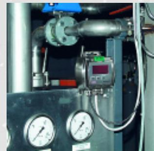
Überwachung des Wassergehaltes im Schmieröl-system einer Papiermaschine
