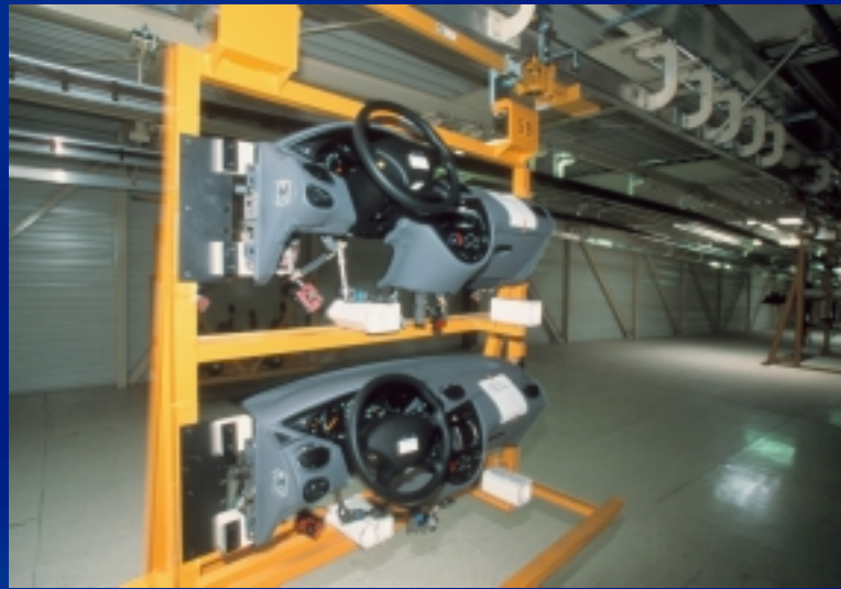
Das alles verbindende, vollautomatische Transportsystem "Conveyer" des Zulieferparks liefert die Einzelbaugruppen direkt vom Hersteller in die Montagehallen der Fordwerke
