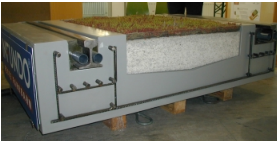
Das Gleisbett zur Lärmreduzierung im Schienenverkehr, entwickelt vom Institut für Straßen- und Eisenbahnwesen
