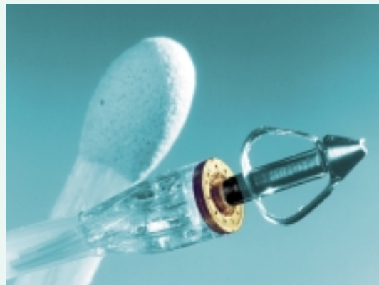
Die LIGA-Mikroturbine ist Bestandteil eines Fräskopfes für die medizinische Anwendung, beispielsweise zur Entfernung von Ablagerungen in Herzkranzgefäßen. (FZK, Karlsruhe)
